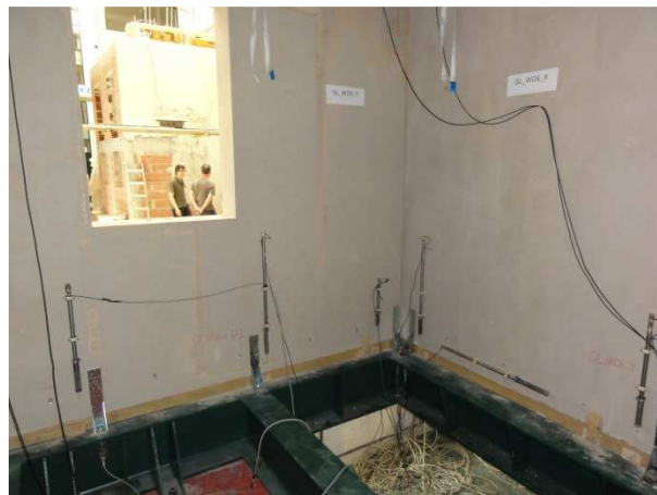
Figura 14: Strumenti di misura. Sx: sistema ottico. Dx: trasduttori di spostamento
