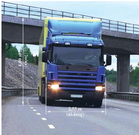
Εικόνα 9. Ύψος και πλάτος φορτηγών οχημάτων, Πηγή: [3]
